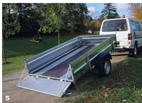
5 Der Anhänger bleibt in der Kippstellung aufladebereit!
